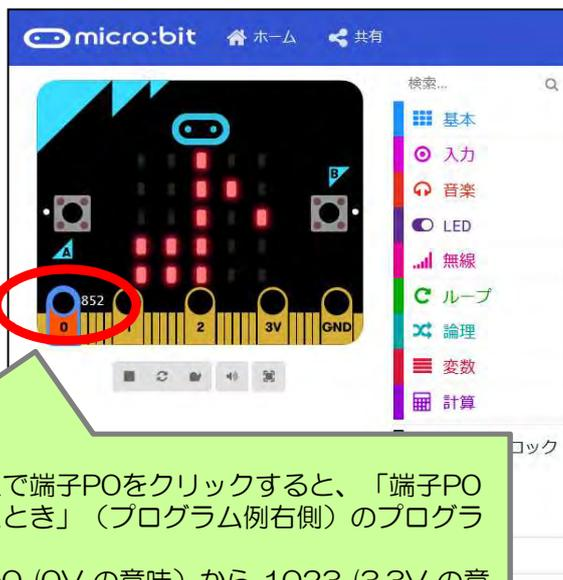
・エディター上で端子P0をクリックすると、「端子P0がタッチされたとき」(プログラム例右側)のプログラムが動く
