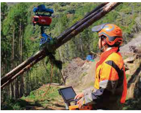
無線リモコン操作で重い木材をつかみ、運搬する様子
