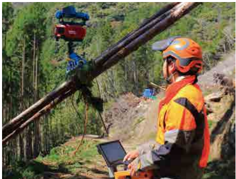
無線リモコン操作で重い木材をつかみ、運搬する様子
