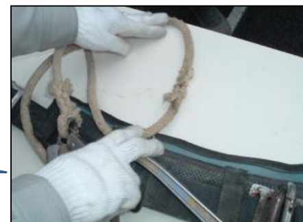
安全帯の点検
