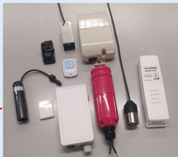
実証実験に用いている浸水センサ
