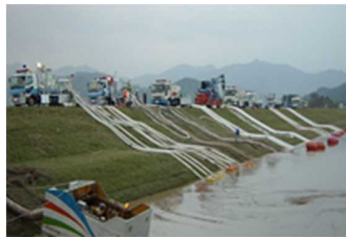
排水ポンプ車による緊急排水
