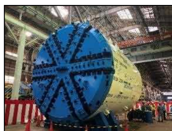
シールドマシン全景 (シールド機外径φ5,900mm)
