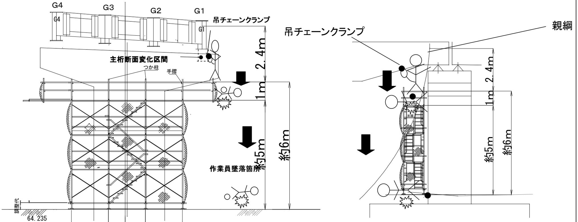
底面足場解体後、被災者はP4橋脚の昇降設備上の桁に設置していた親綱を撤去する作業を行う為、桁に設置している吊チェーンクランプに安全帯を掛けた後、昇降設備の足場パイプに乗った際に足を滑らせ、1度昇降設備上の布板に落下し、その時の衝撃で吊チェーンクランプが外れ、約5mの高さから墜落した。
