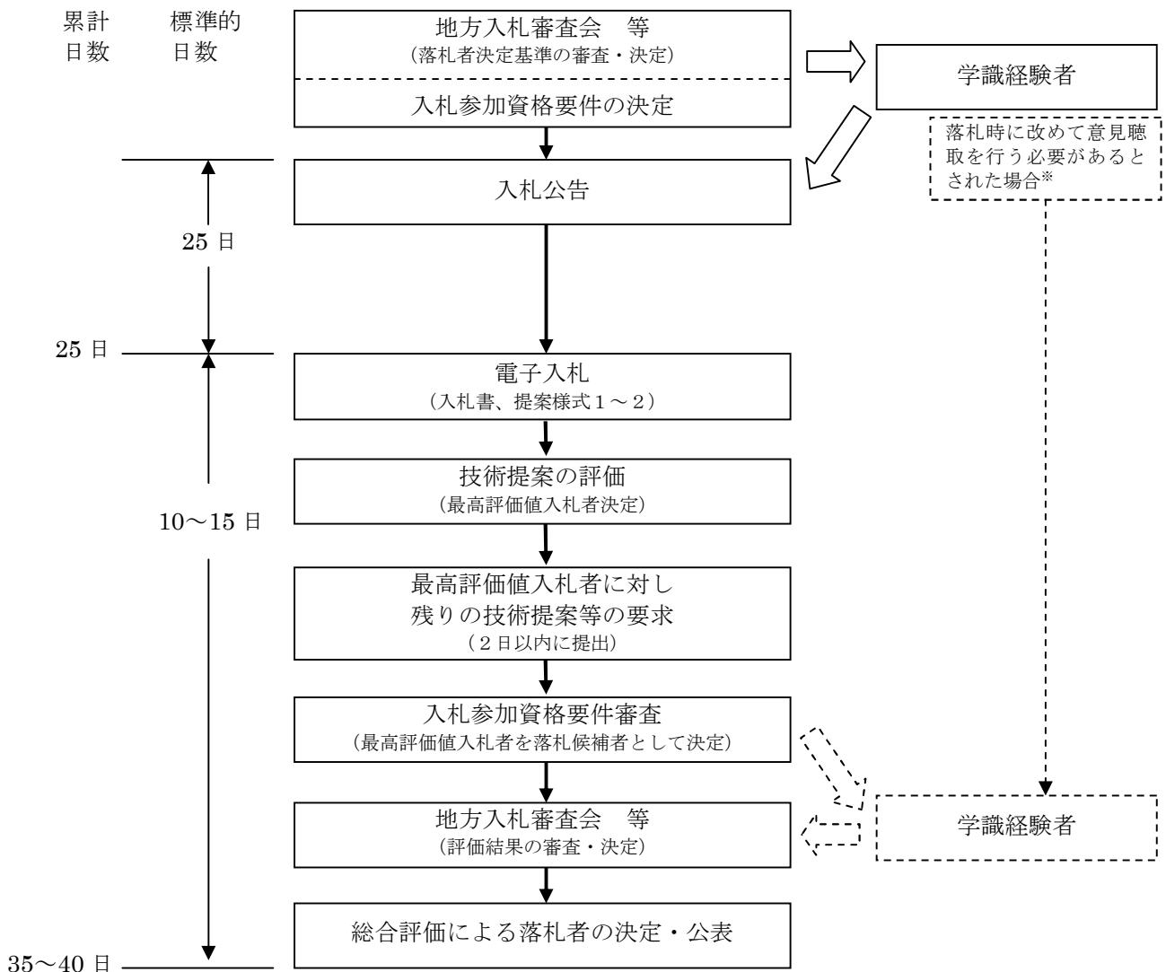
図-3 簡易型フロー図
