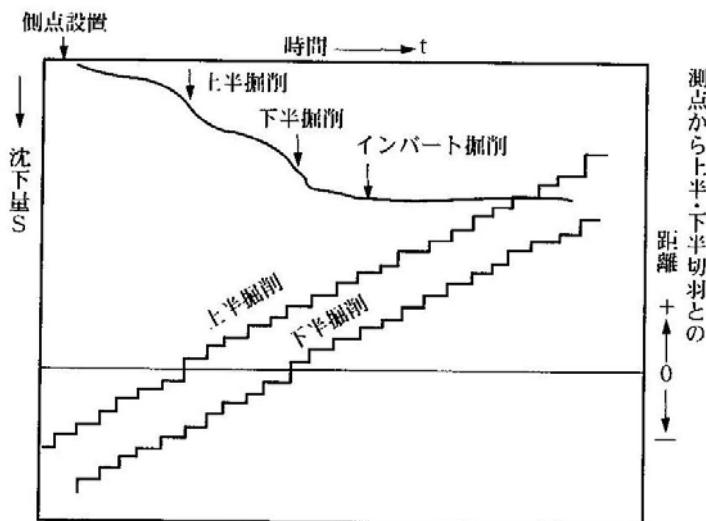
図 6-11 地表沈下量経時変化
