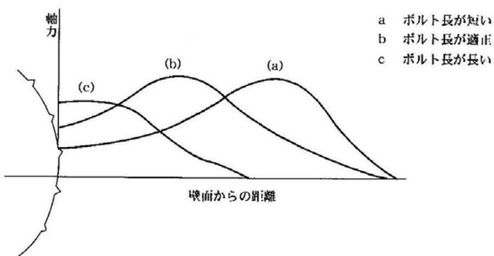
図 6-4 ロックボルトの軸力分布
