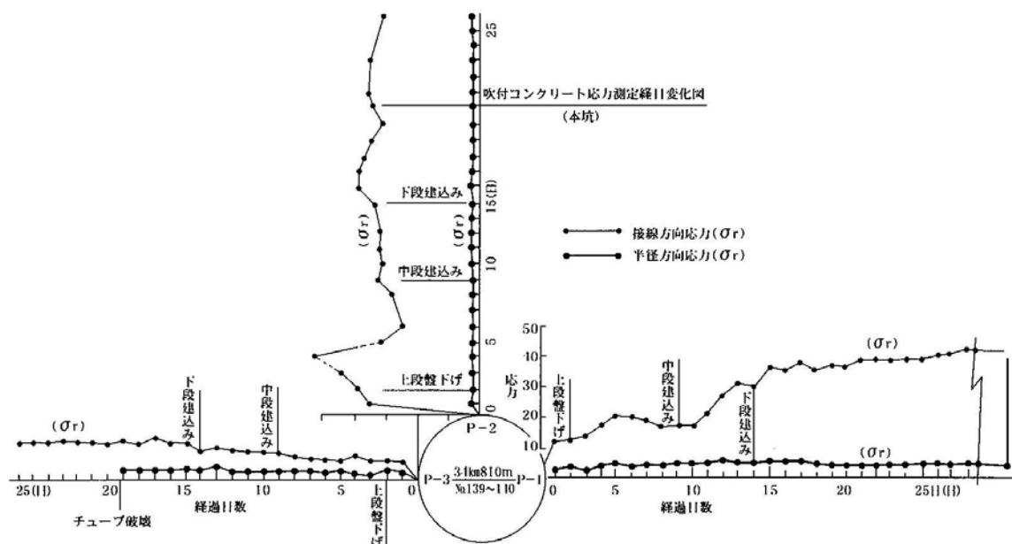
図 6-6 吹付コンクリート応力分布図
