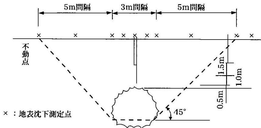
図 6-9 地中沈下測定点の配置例
