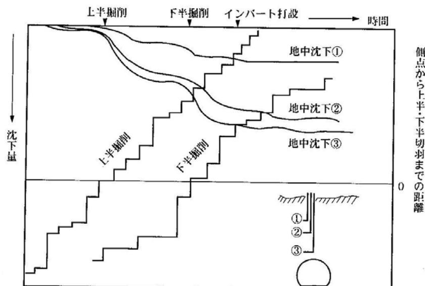
図 6-12 地中沈下量経時変化
