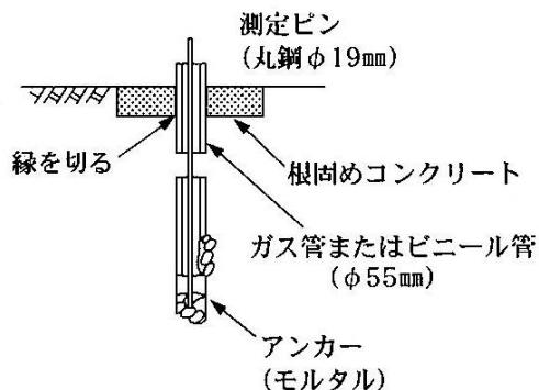
図 6－8 地中沈下測定点の設置例
