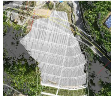
GNSS受信機を搭載したローラー車による転圧状況とガイドモニター
