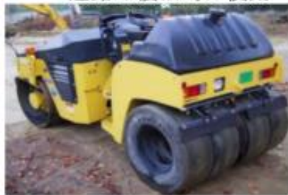
(振動ローラ) ・・・道路の復旧時に使用
