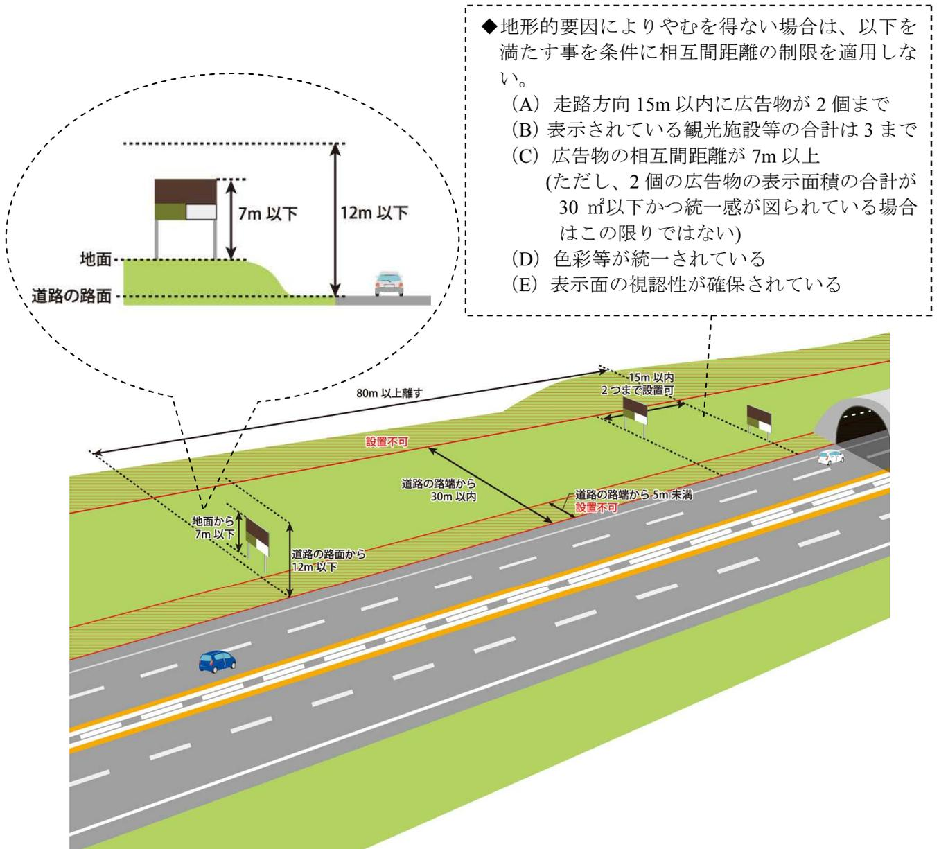
■設置基準の概要図(断面)
