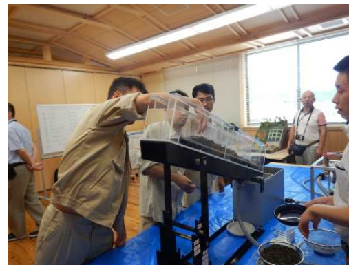
小型模型水路を用いて土石流の再現や砂防えん堤の捕捉効果を実演
