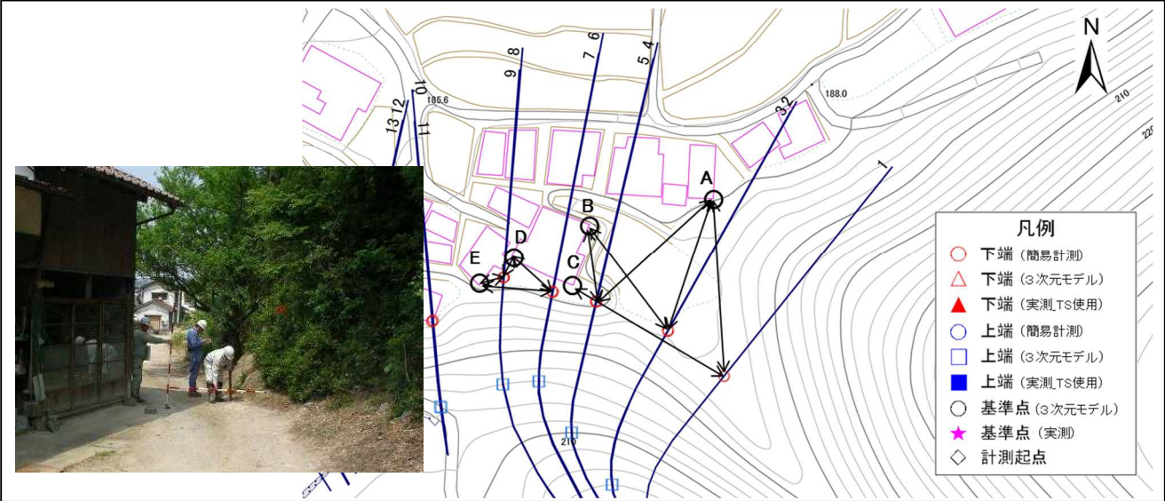
図 II - 3.8 オフセット計測の事例
