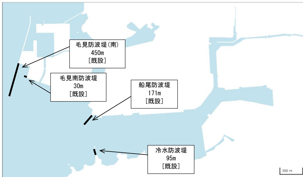
図 III-3-1 (3) 防波堤計画の現況（和歌浦海南港区）
