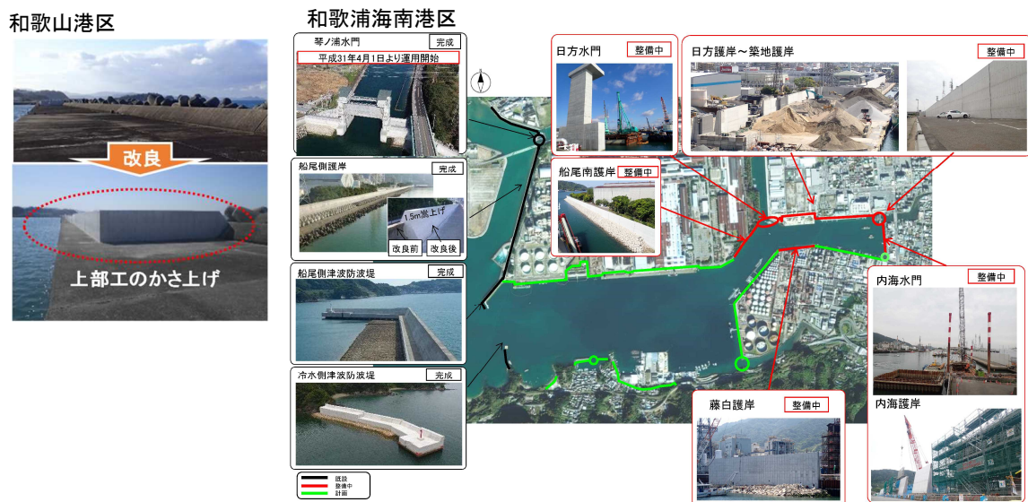
図 5.16 耐震強化岸壁の整備状況（既定計画）
