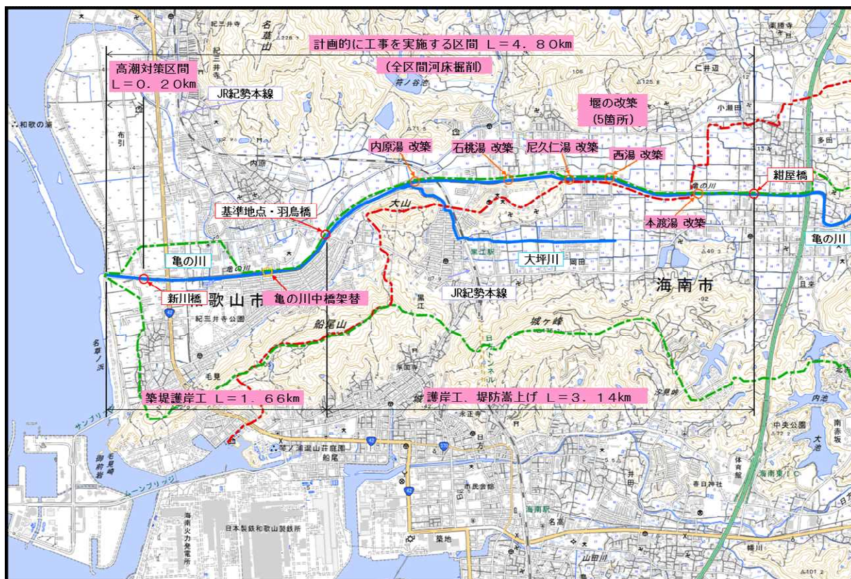
図 5 亀の川河川改修の概要
