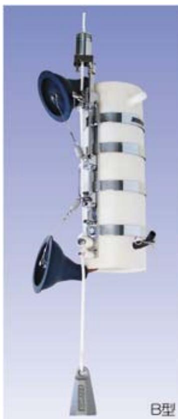
図 2.2-2 バンドーン採水器
