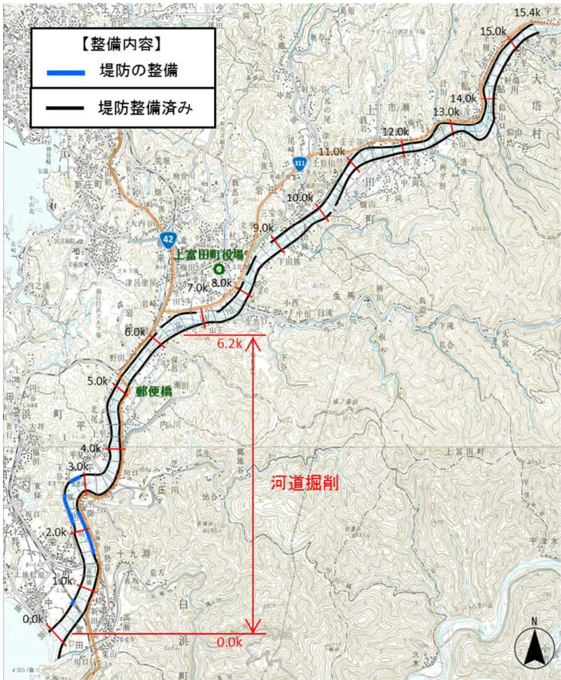
図 11 計画的に河川工事を実施する区間
