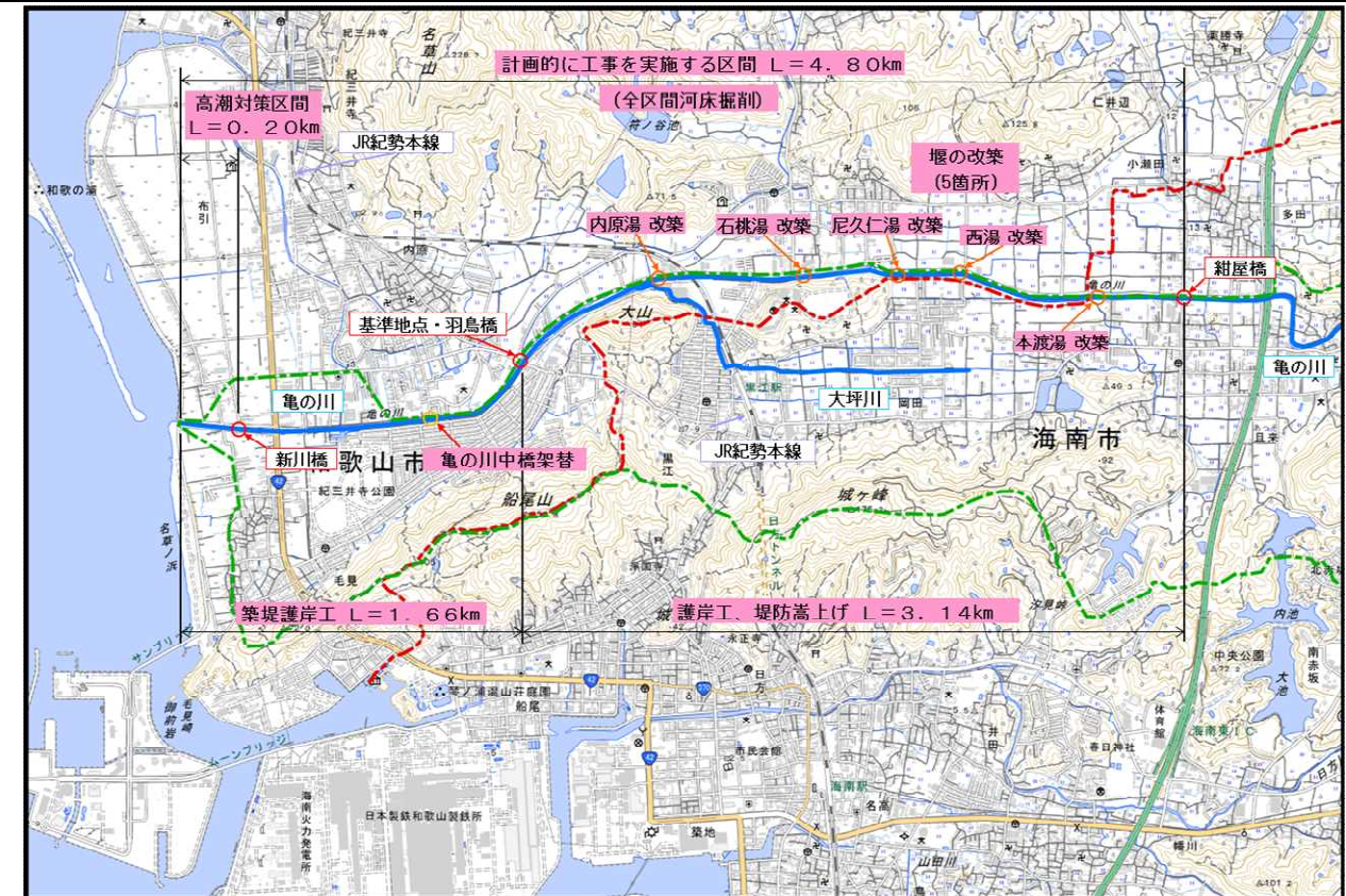
図 5 亀の川河川改修の概要
