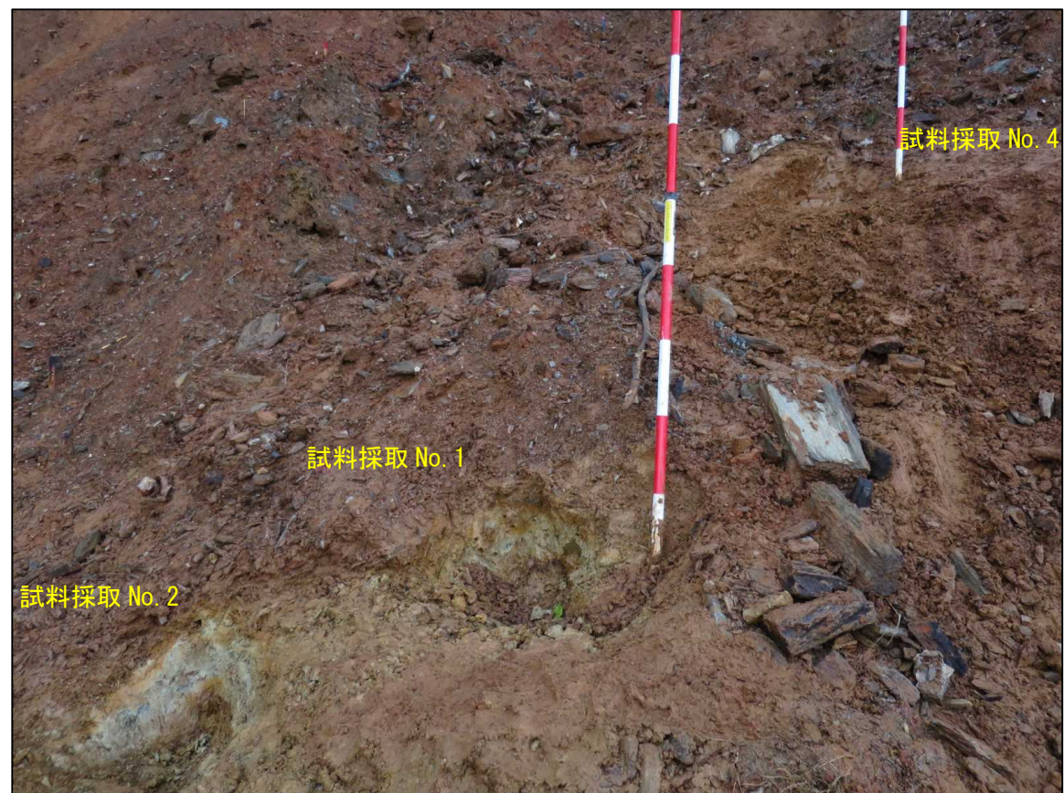
写真 4.3 不攪乱試料採取地点 No.1, No.2, No.4 近景。試料採取地点には強風化岩（D層）が分布する。特に、No.1, No.2 地点には、灰白色の粘土層が斜面に対し流れ盤構造で分布する。
