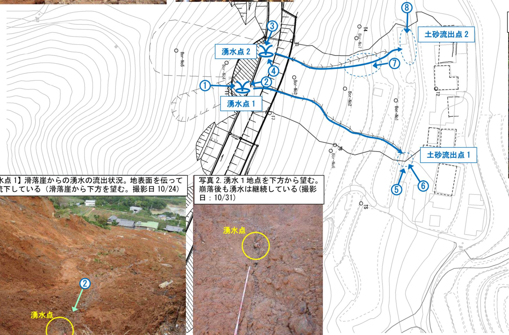
写真1. 【湧水点1】 滑落崖からの湧水の流出状況。地表面を伝って斜面下方へ流下している（滑落崖から下方を望む。撮影日 10/24）
