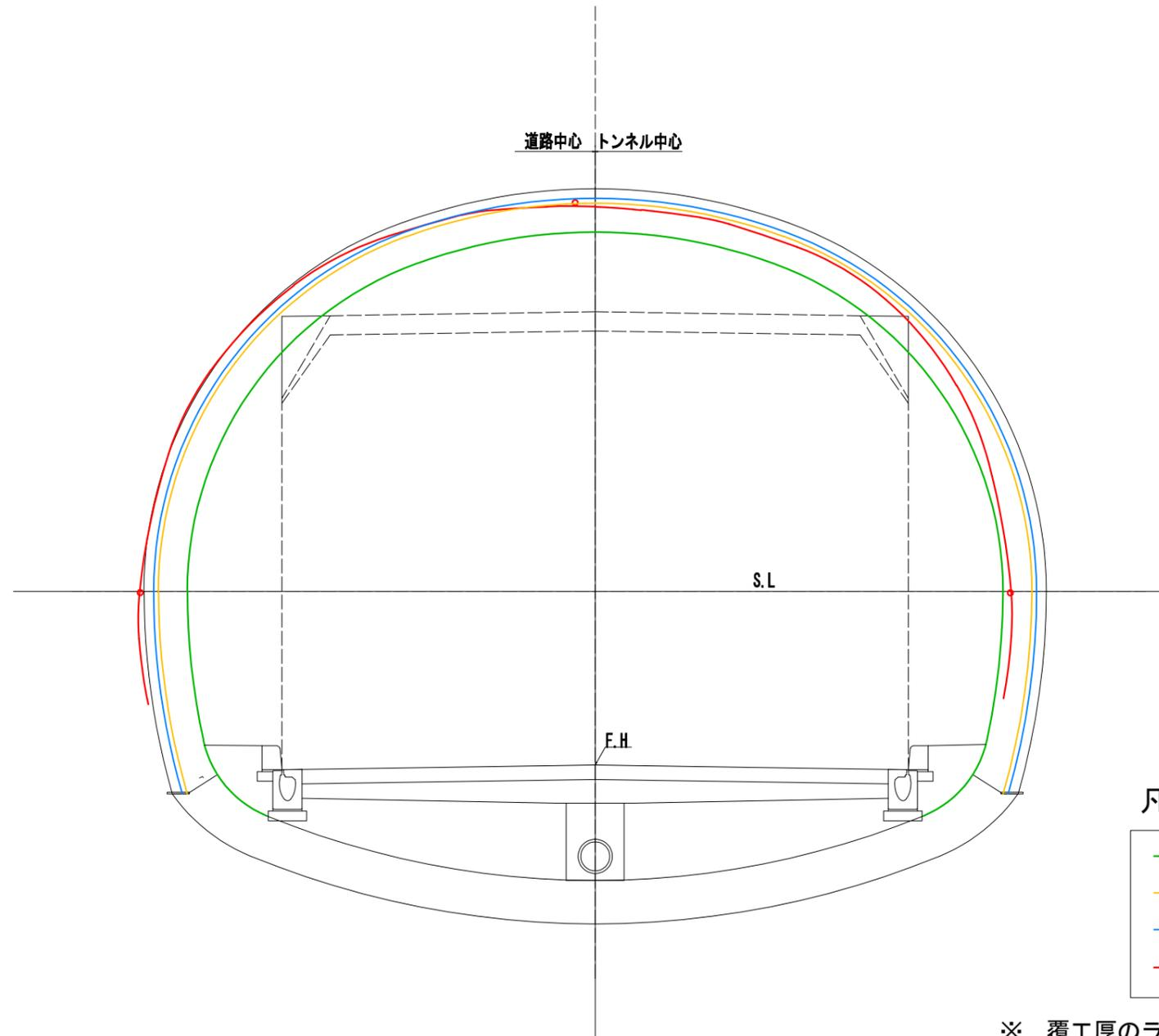
※ 覆工厚のラインは、設計における覆工背面の位置を示している。
