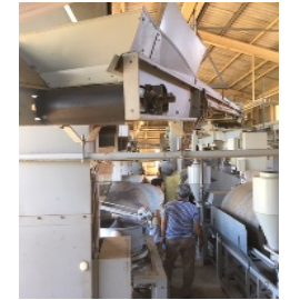
有機食品等の輸出向け商品の製造ライン増設 茶葉→荒茶への製造ライン（蒸熱・冷却・揉捻）
