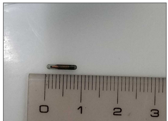
図2 PIT タグ （長さ：約8.4mm，重さ：約0.03g）
