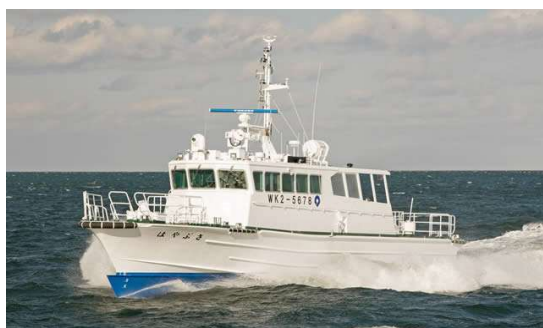
漁業取締船「はやぶさ」平成28年12月竣工 総トン数38トン 最大速度36ノット
