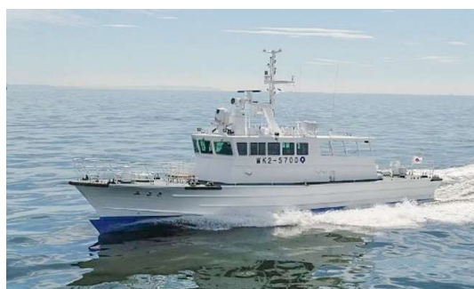
漁業取締船「みさき」令和7年9月竣工 総トン数40トン 最大速度34ノット
