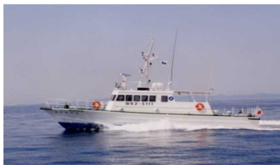
漁業取締船「新はやぶさ」平成7年3月竣工 総トン数33トン 最大速力32.2ノット
