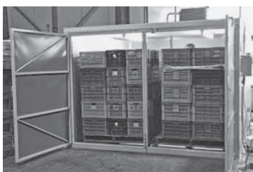
写真2 JAに設置された追熟庫
