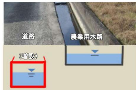
道路などの下に新たに農業用水路を埋め込むなどにより、排水を流下させる能力を高めます。
