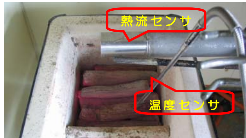
写真2. 発生熱量及び表面温度の測定
