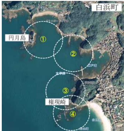
図3 超音波受信機設置場所(①~④)、点線円は概ねの受信範囲で半径200m)
