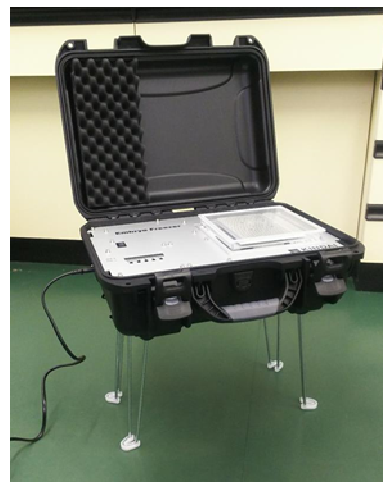
図2 試作した簡易プログラムフリーザーの収納状態（写真左）および設置状態（写真右）
