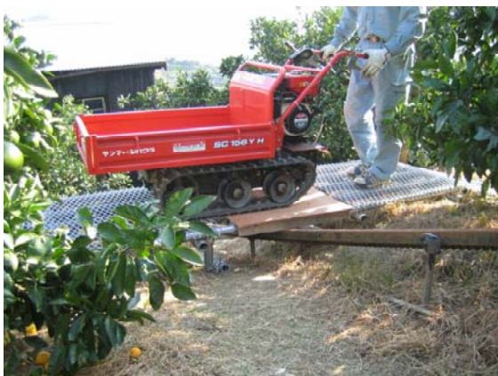
図3 モノレール乗り越え用スロープ
