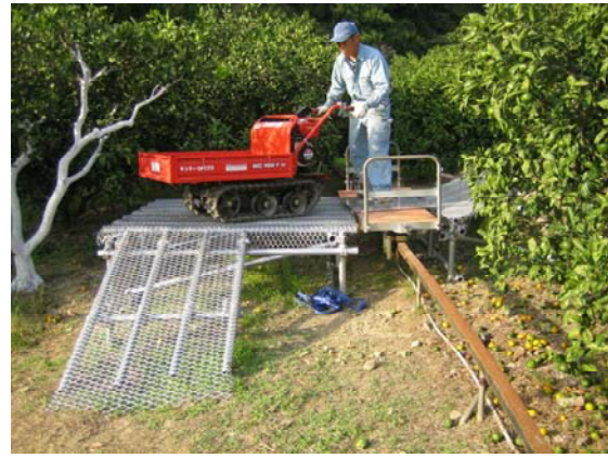
図1 単軌条運搬機からテラスへの乗降車 (左:モノレール支線式 右:プラットフォーム式)
