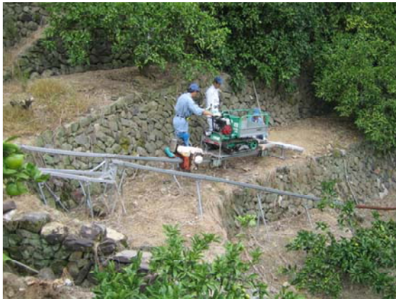
図1 単軌条運搬機からテラスへの乗降車 (左:モノレール支線式 右:プラットフォーム式)
