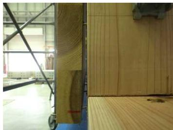
釘抜けによる面材の浮き上がり
