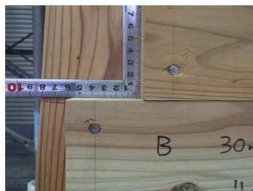
面材の水平方向のずれ (55mm 程度)
