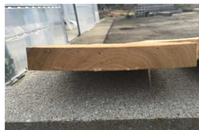
図2 乾燥による材の損傷状況(天然乾燥+人工乾燥)
