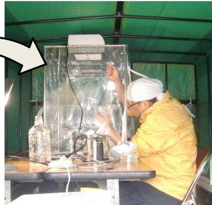
作業環境を安定させるため、トラック荷台を凍結作業室として使用
