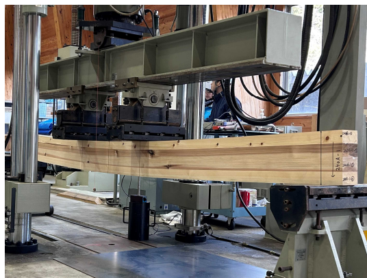
図 5 曲げ強度試験 (株式会社東京衡機製造所製 A094101)
