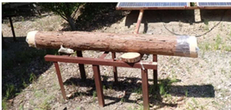
図2 林業試験場研修グラウンド周辺における 皮付きヒノキ材の設置状況
