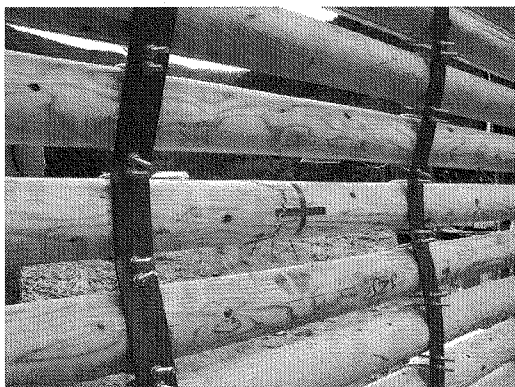
第21図 重錘振り試験結果(2.73m)
