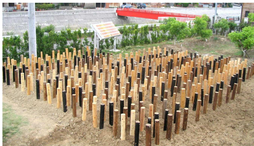
第5図 縦杭耐久試験の当初設置状況
