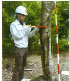
(写真5 胸高直径の測定)
