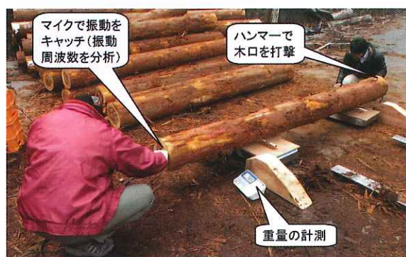
図2 原木の動的ヤング係数測定方法
