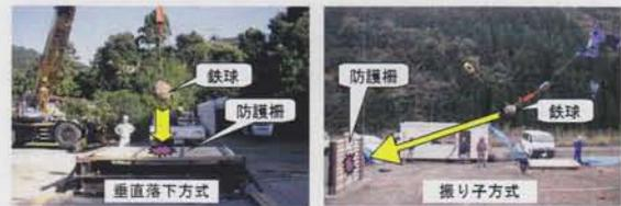
写真1 木製落石防護柵の実証試験
