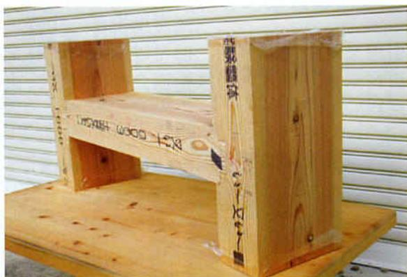
図-1 蟻継ぎによる試験体
