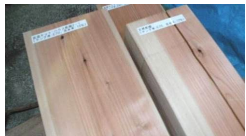
スギ平角乾燥材 (左) 高温セット処理後にハウス乾燥 (右) 天然乾燥
