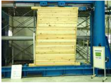
面内せん断試験の実施状況
