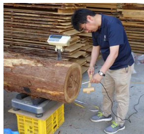
大径原木の調査状況 （振動解析器使用）
