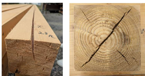
図 1 表面割れ（左）と内部割れ（右）
