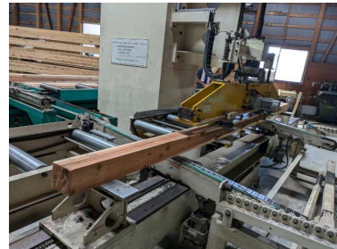
図2 曲げヤング係数測定の様子
