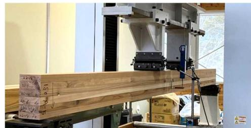
図4 曲げ強度試験
